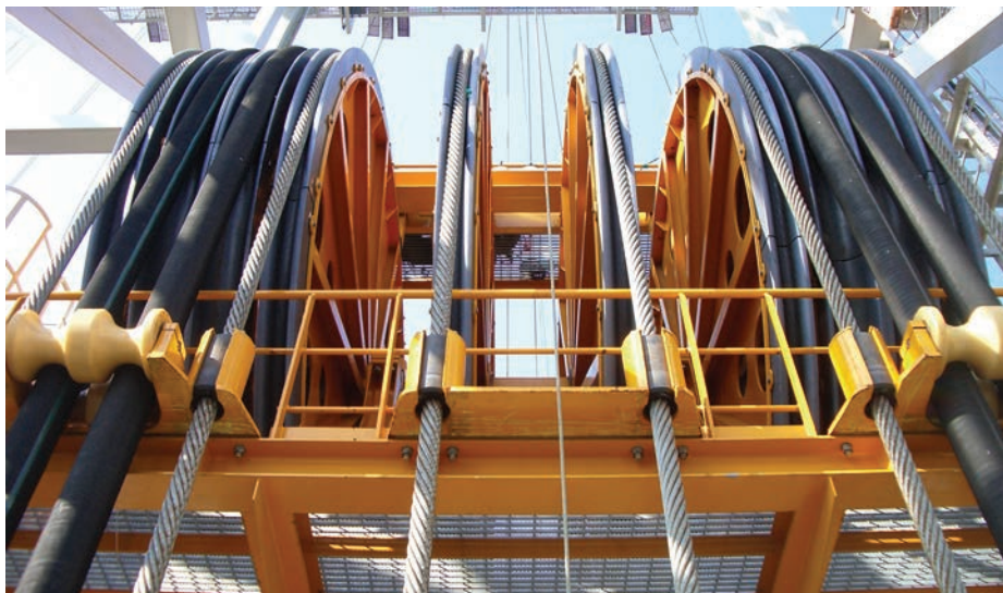
Mitsubishi Chemical Advanced Materials levert een kunststof kabelschijf die staalkabels beter geleidt en slijtage vermindert. Foto: MCAM.
