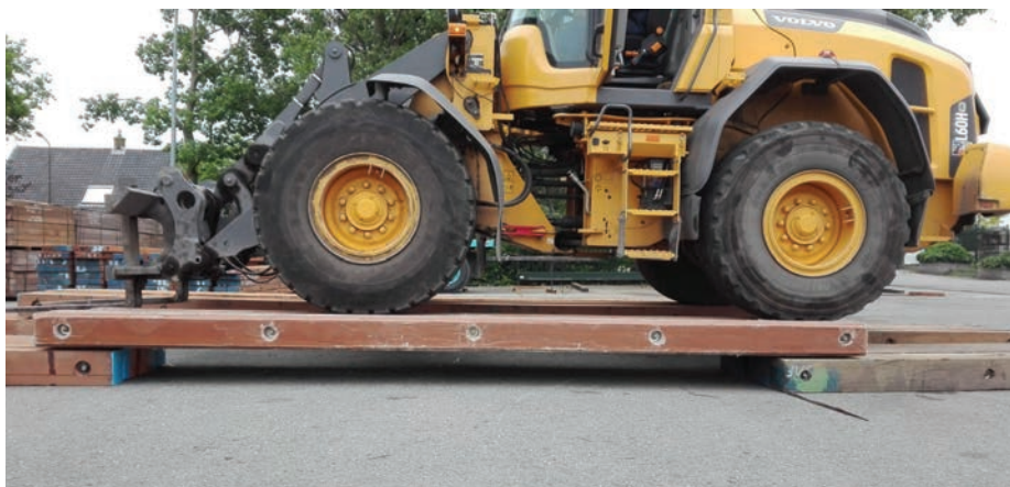
Binnen het RAAK-MKB-Project zijn verschillende succesvolle demonstrators van hergebruikt composiet gemaakt, zoals dit draglineschot.
