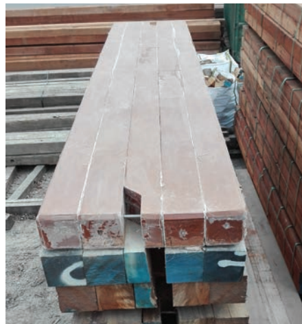
Binnen het RAAK-MKB-Project zijn verschillende succesvolle demonstrators van hergebruikt composiet gemaakt, zoals dit draglineschot.
